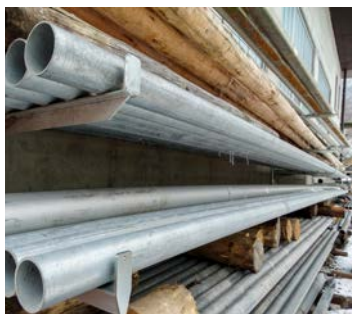
Fig. 14 Tubi di metallo, lunghezza 6 m, diametro 2 pollici – in scorta, da tagliare in base al fabbisogno
