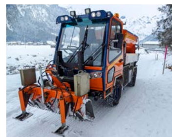
Fig. 17 Veicolo a carreggiata stretta utilizzato per la manutenzione dei sentieri escursionistici invernali
